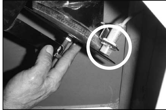
Abb. 30 Durch leichtes Andrücken, Klappe schließen. Abstand Klappe-Sensor : 2-3 mm
