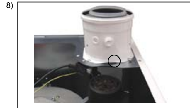
8) Nach Abnahme des oberen Verkleidungsdeckels Blechschraube Arretierung Luft- / Abgasrohr lösen.
