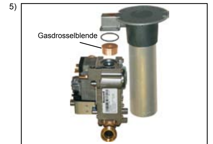
Eingebaute Gasdrosselblende entfernen und durch die für die neue Gasart bestimmte Gasdrosselblende (nach Tabelle Seite 25) ersetzen.
